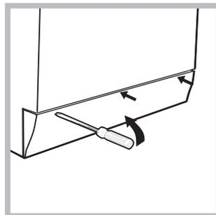
1. свалете панела в предната част на пералната машина с помощта на отвертка (вижте фигура);
