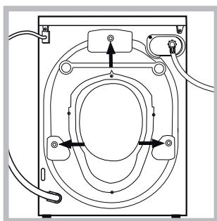
3. Csavarozza ki a gép hátsó részén található, a szál-lításhoz szükséges 3 védőcsavart, és távolítsa el a gumi-bakot (lásd ábra).
