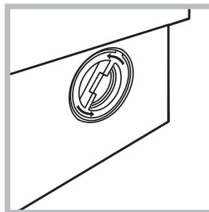
2. odšroubujte víko jeho otáčením proti směru hodinových ručiček (viz obrázek): vytěčení malého množství vody je zcela běžným jevem;
