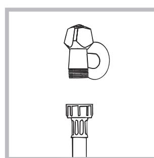
1. Συνδέστε το σωλήνα τροφοδοσίας βιδώνοντάς τον σε ένα κρουνό κρύου νερού με στόμιο σπειρώματος 3/4 gas (βλέπε εικόνα). Πριν τη σύνδεση, αφήστε να τρέξει το νερό μέχρι να γίνει διαυγές.
